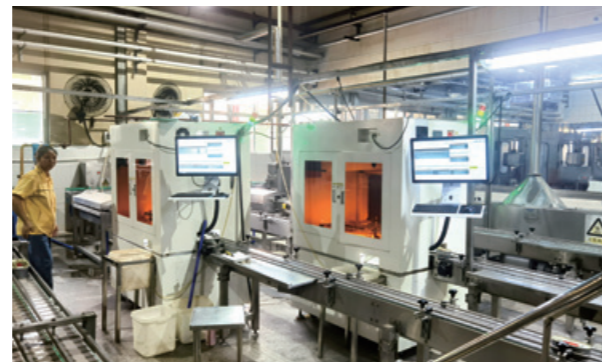
鹰金钱公司罐边封口多光谱视觉检测
